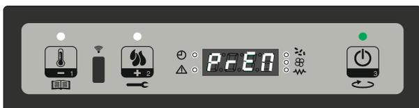
Premere quindi P2 (aumento). Il ventilatore fumi si accende alla massima velocità, la coclea si accende (led coclea acceso) e vi rimangono fino ad esaurimento del tempo indicato sul display; se si intende fermare il carico della coclea anzitempo, pressione del tasto P3.
