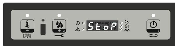
Se la temperatura ambiente, scende al di sotto della temperatura impostata (Set ambiente) + un delta a parametro tecnico (solitamente 3°C), l'apparecchio effettua una nuova accensione.
