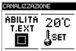
Pressione dei tasti  $\uparrow\downarrow$  per attivare/disattivare la spunta, se si desidera gestire la temperatura della zona da canalizzare con l'ausilio di un termostato esterno (non fornito). Tasto **OK** per conferma.
