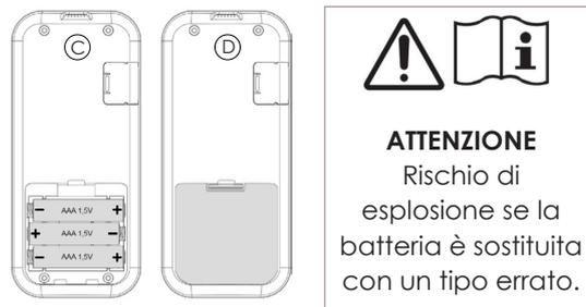
Le batterie, una volta esaurite, devono essere smaltite negli appositi centri di raccolta dedicati. Per proteggere la batteria da condizioni avverse o uso improprio, ricordarsi di:
