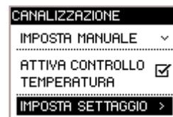
**!** Se, non collegando la sonda, si attiva erroneamente il CONTROLLO TEMPERATURA, la ventilazione non si ferma mai, in quanto il sistema riceve un valore di 0 °C.
