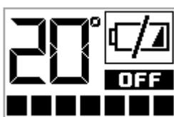
Non appena il livello delle batterie non permette in alcun modo la comunicazione radio, il palmare mostra, a schermo intero, l'immagine della batteria scarica, bloccando tutte le funzioni a lui connesse fino ad avvenuta sostituzione delle batterie.
