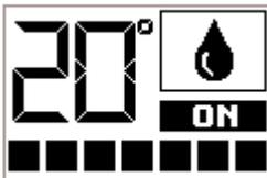
Quando il sistema si attiva, in seguito alla rilevazione di una temperatura troppo bassa dei fumi di scarico, sul display del telecomando la fiamma viene sostituita da una **goccia di acqua**. Al salire della temperatura dei fumi la visualizzazione a display viene ripristinata e il sistema anti condensa disattivato.
