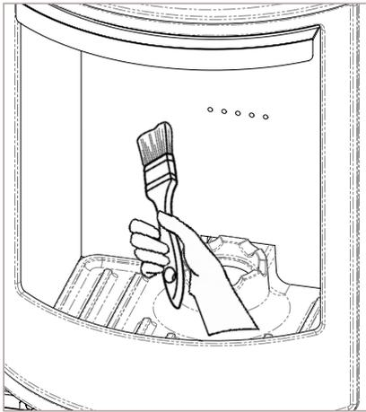
Aspirare il piano di combustione di ghisa e il pozzetto del braciere, facendo attenzione a non urtare col beccuccio dell'aspiratore il rivestimento in vermiculite, per non danneggiarlo.
