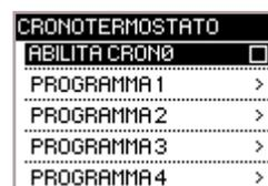
Il cursore si posiziona sulla riga di attivazione / disattivazione tramite il tasto **OK**. Quando nel quadrato appare una spunta, il cronotermostato risulta attivato. Per disattivarlo ripremere **OK**.
