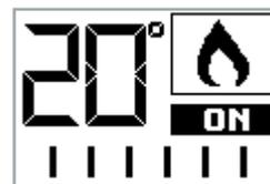
La comparsa dell'icona "fiamma" con la dicitura ON senza l'indicazione della potenza di lavoro segnala che la stufa è in una di queste 3 fasi. Dopodiché la stufa si porta in fase lavoro evidenziando anche la potenza. Nell'esempio seguente è riprodotta la potenza 7.
