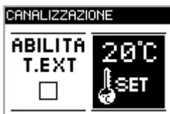
Pressione dei tasti  $\uparrow\downarrow$  per impostare la temperatura della zona da canalizzare con l'ausilio della sonda ambiente fornita nel kit e collegata alla morsettiere.
